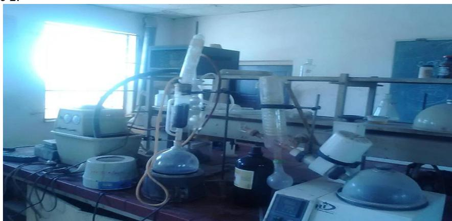
Figure 2; Soxhlet Extractor and Accesories
